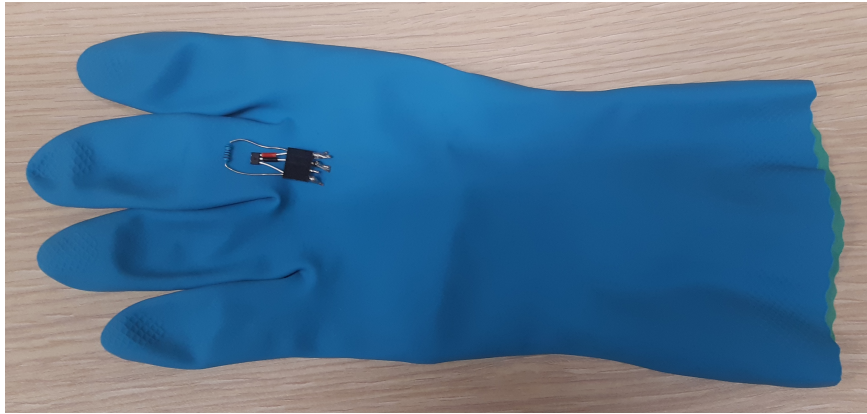
Figura 2.4: Primo prototipo del guanto (sensore sul medio)
